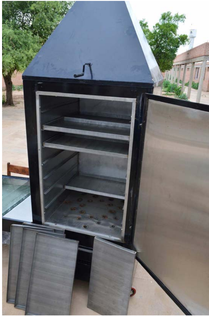
Trockenkammer und Trockenbleche aus rostfreiem Stahl. Man sieht die Löcher am Boden, durch die die Luft dringt, die in der Feuerkammer und durch die Sonnekollektoren erhitzt wird.
