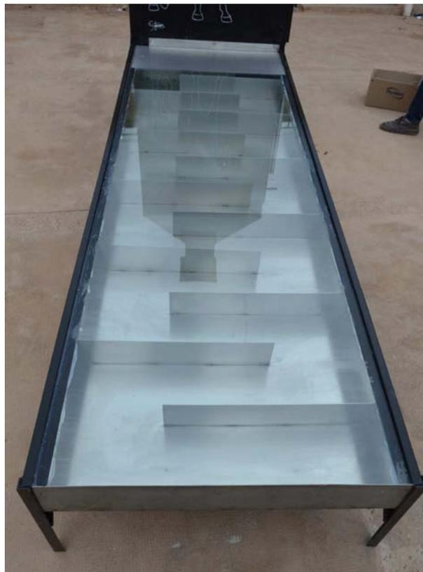
Colector solar. Se observa el frente vidriado que oficia de trampa al calor del sol, y los deflectores que ralentizan el movimiento ascendente del aire para que eleve aún más la temperatura.
