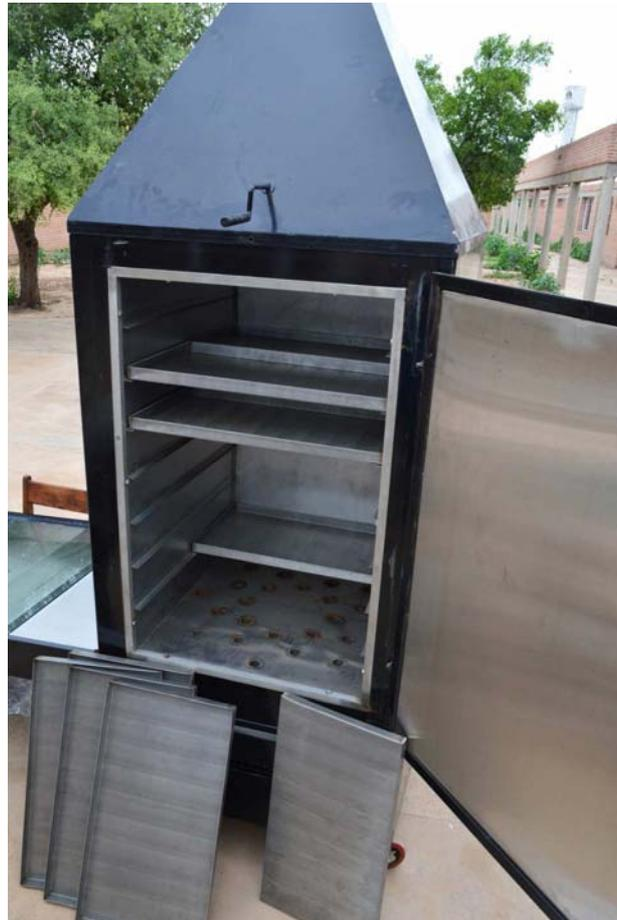
Cámara de secado y bandejas todo en acero inoxidable. Se ven en la base de la cámara de secado los agujeros por donde ingresa el aire caliente que proviene del colector solar y del fuego.
