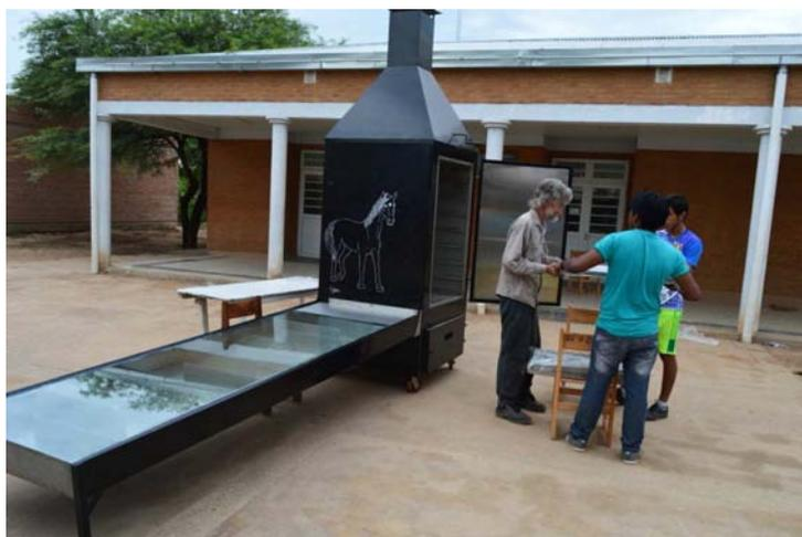
Preparando la introducción de bandejas portadoras de fruta en la cámara de secado con alumnos de 6º año.
