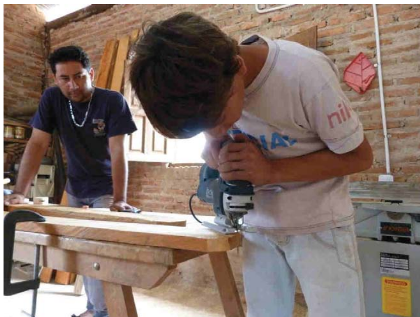
Daniel, utilizando la caladora moldea uno de los parantes de la tranquera
